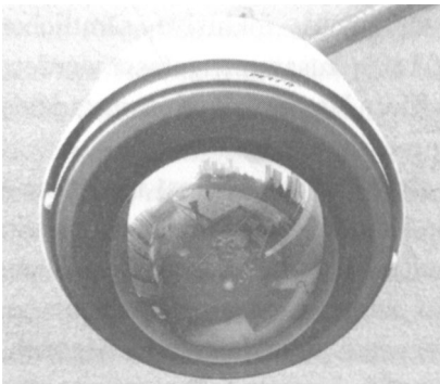
Abb. 2.11.1: Optische Komponente des BRS-Systems zur Verbrechensvorhersage.
